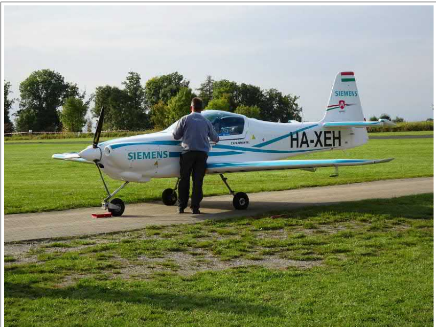
Komplett elektr. angetriebenes Flugzeug von Siemens Magnus eFusion
