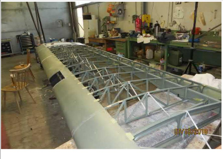
Die Flügel bestehen aus Aluminiumrippen und zwei Holmen. Alles ist mit kleinen Blechschrauben verschraubt. Pro Flügel müssen sieben Rippen ausgetauscht werden. Dazu müssen geschätzte 600 Schraubchen entfernt, die Teile ersetzt und alle Schrauben wieder eingesetzt werden.
