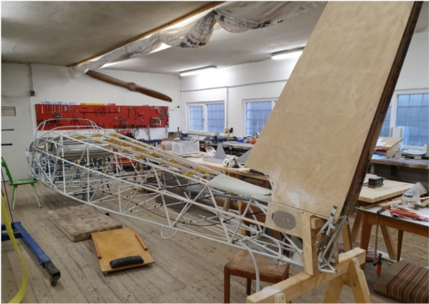
Rumpfgerüst mit Seitenleitwerksflosse
